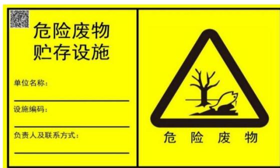
危险废物贮存标志牌示意图（危险废物设施标志背景颜色为黄色，RGB 颜色值为（255，255，0）。字体和边框颜色为黑色，RGB 颜色值为（0，0，0）；危险废物设施标志字体应采用黑体字，其中危险废物设施类型的字样应加粗放大并居中显示；三角形警告性图形与其他信息间宜加黑色分界线区分，分界线的宽度宜不小于 3mm。）
